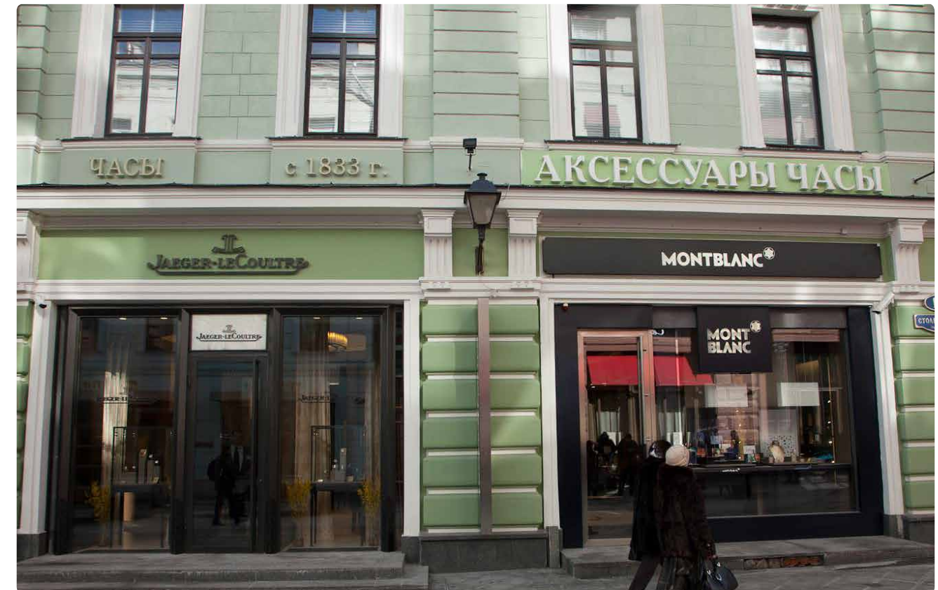
Вывеска на фризe слева меньше вмешивается в архитектурный облик здания и поэтому является более удачной
